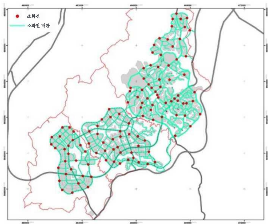
그림 5-61 KIPP 소방 시스템 및 소화전 네트워크 계획
