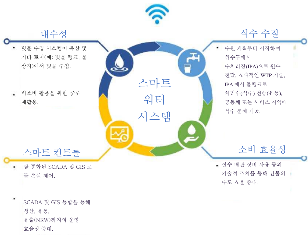
그림 5-51 스마트 수도 관리 기술 시스템(스마트 워터)
